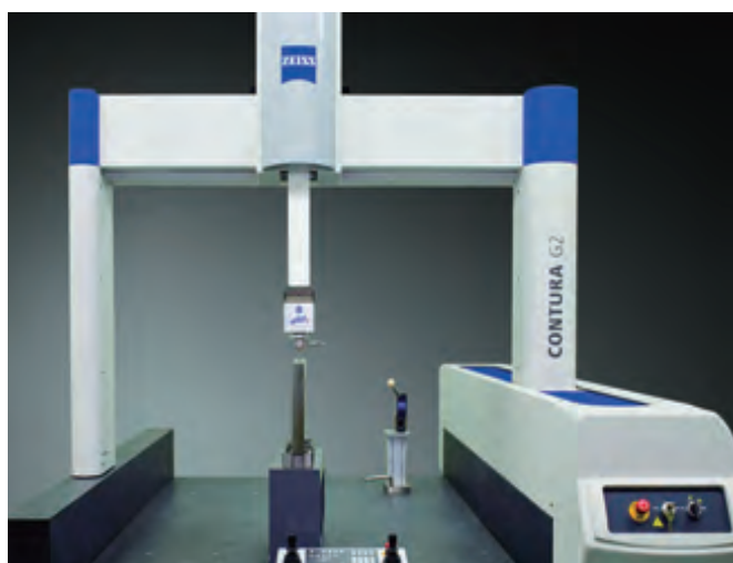
構成部品は三次元測定機で検査を行い、機械精度を保証。
